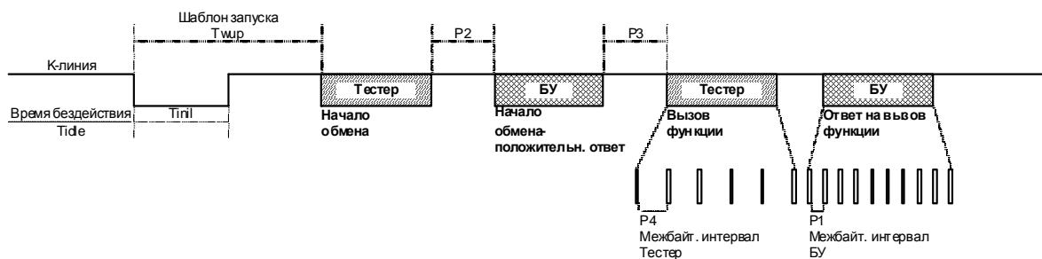
CPR\_017 Значения временных параметров ускоренной инициализации и обмена данными в целом приведены в нижеследующих таблицах. Время бездействия может быть различным:
