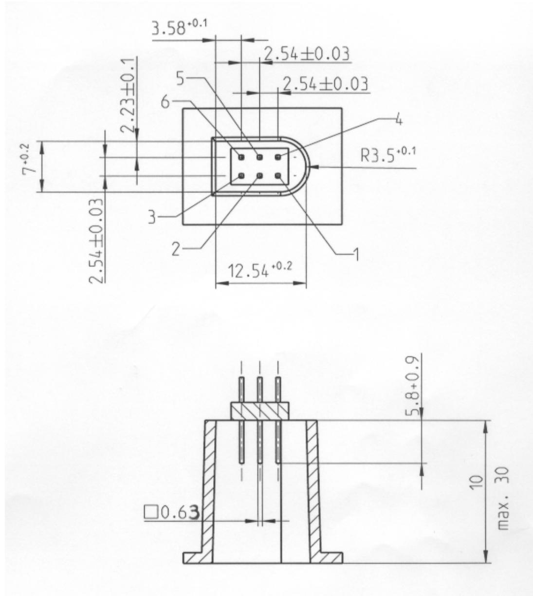
Типовая схема вилки 6-контактного штепсельного разъема:
